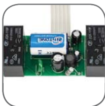
Два встроенных реле на токи до 16 А
